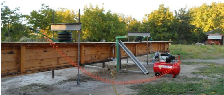
Рис. 2. Испытания двутавровой клеодощатой армированной балки на испытательном полигоне кафедры МД и ПК
