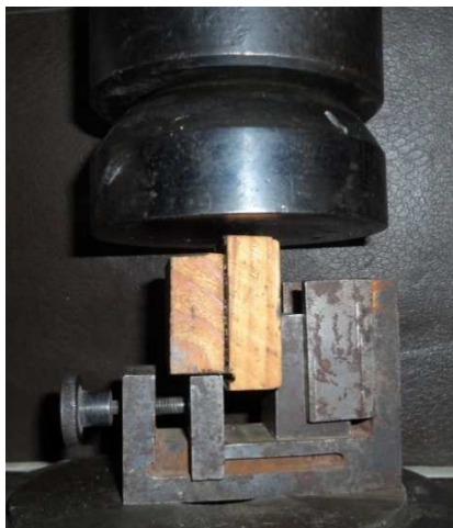
Рис. 4. Испытание клевого соединения на скалывание
