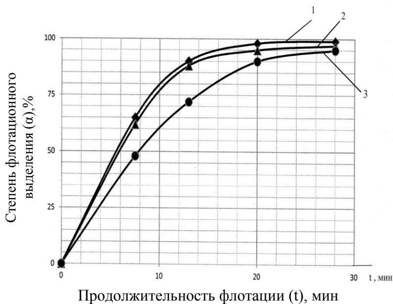
Рис. 2. Кинетика флотационного выделения дисперсной фазы нефти (1), минерального масла (2) и мазута (3) из их 0,75%-ных водных эмульсий, содержащих добавку 0,1 г/л ГИПХ –3А; рН среды – 6,5
