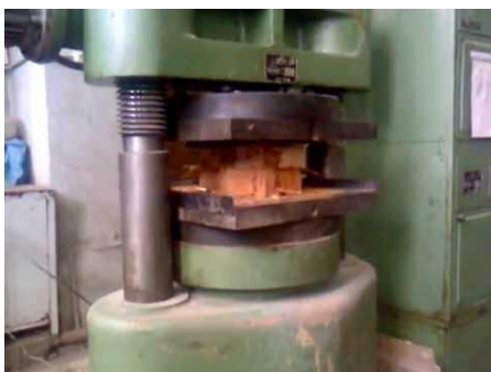
Рис. 1. Випробування на стиск: а – руйнування зразків; б – схематичний вигляд
