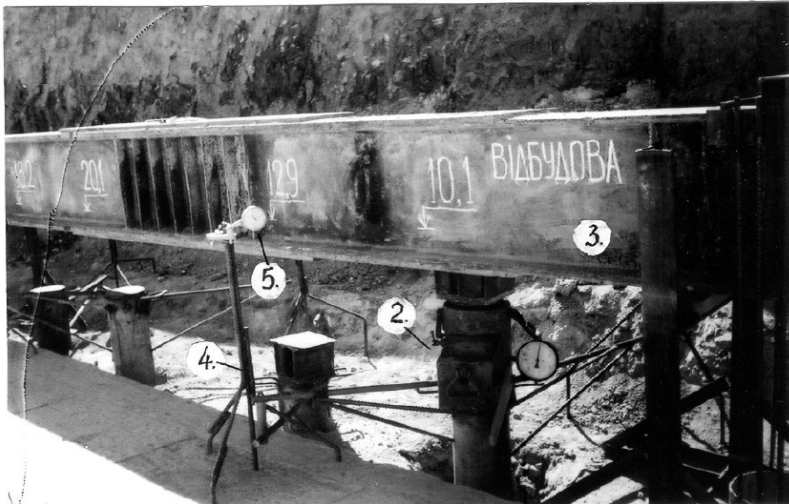
Рис. 4.28. Общий вид испытательного комплекса. 1. Штатпы-стойки. 2. Домкрат ДГ-100. 3. Опорная балка. 4. Реперная система. 5. Прогибомер 6 ПАО. 6. Анкерная свая
