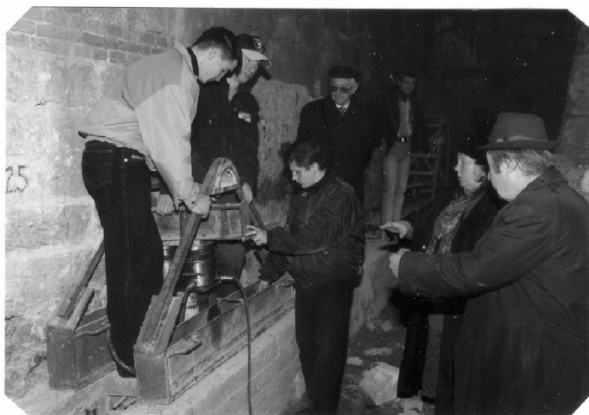
Рис. 6.13. Фотоснимки силовых установок для испытаний (а) и «обжатия» (б) свай
