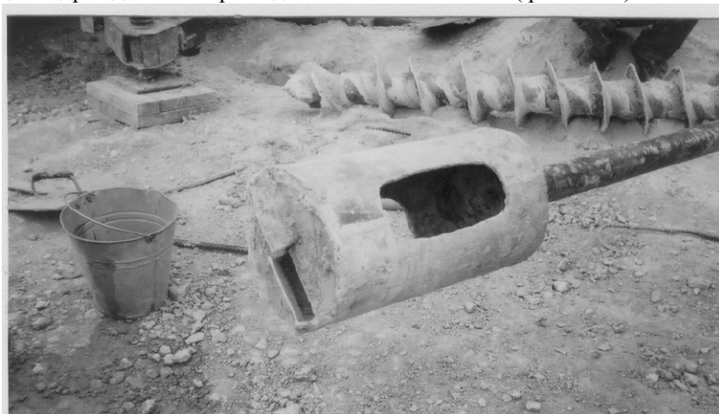
Рис. 4.25. Заборник для зачистки забоя скважин
