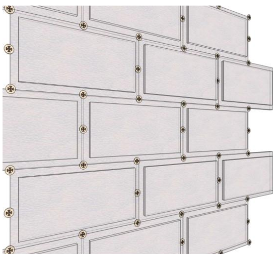
Рис. 3. Технологічна схема розташування дюбелів (6 шт/м 2 )
