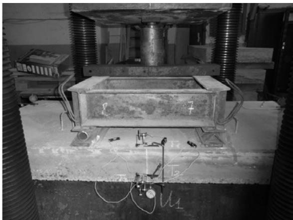
Рис.2. Схема передачі навантаження і місця розташування приладів при випробуваннях
