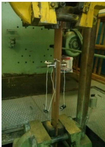
Рис. 3. Испытание металлических лент усиления а – общий вид испытательной установки; б – схема испытания
