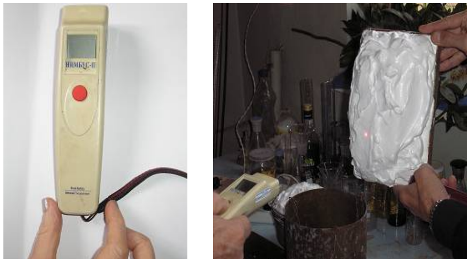
Рис.1. Измерение теплопроводности с помощью пирометра
