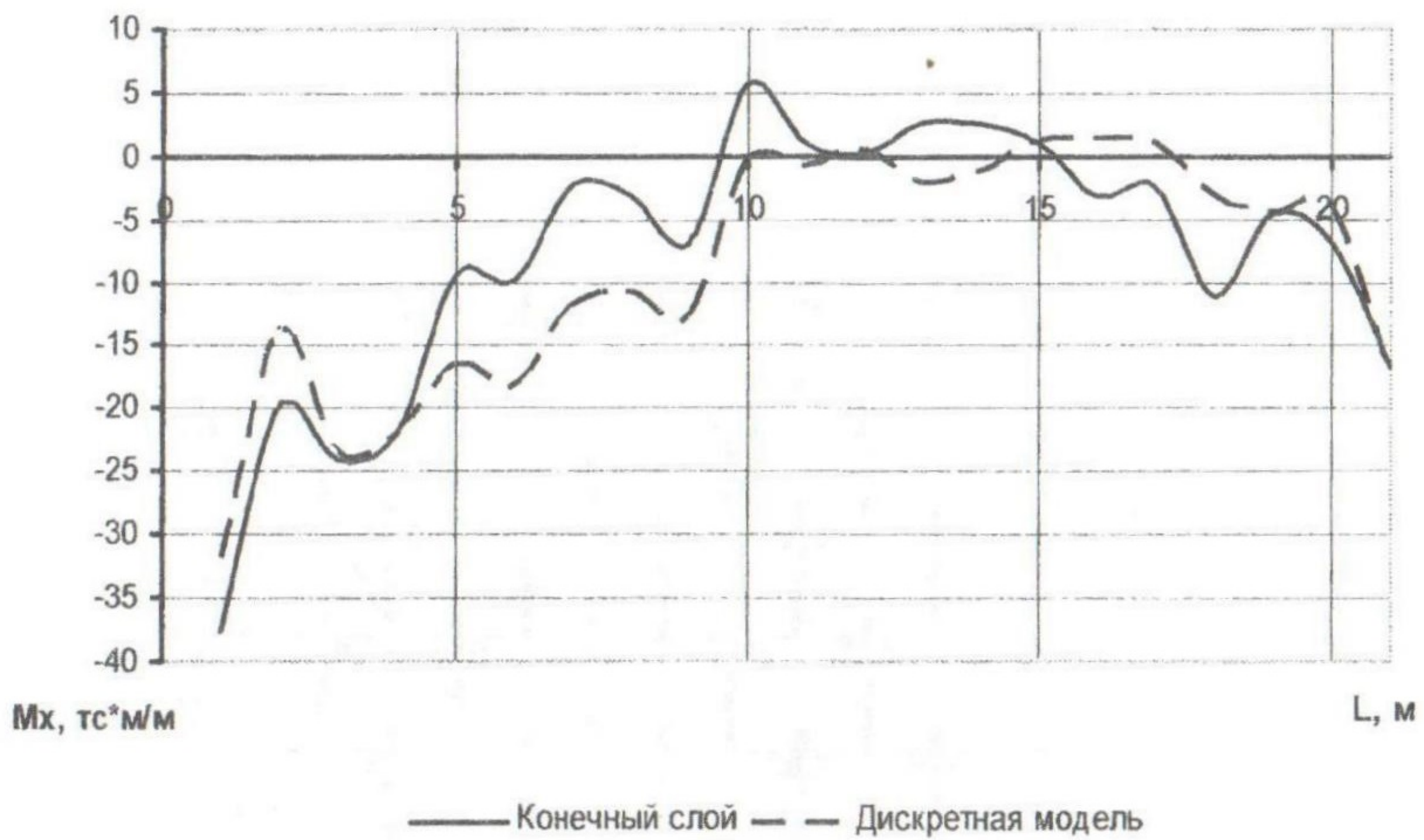
Рис. 5. Изгибающие моменты ( M_x ) в плите ростверка
