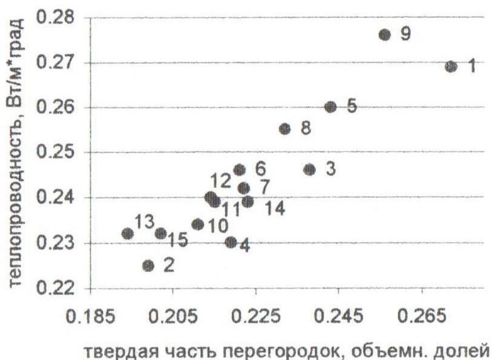
Рис. 3. Влияние на теплопроводность твердой части перегородок пенобетона.
