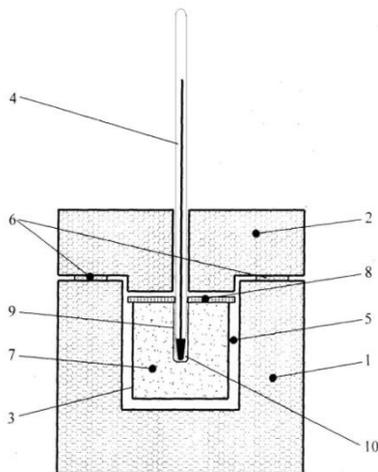
Рис. 1. Калориметр термосного типа из пенопласта
