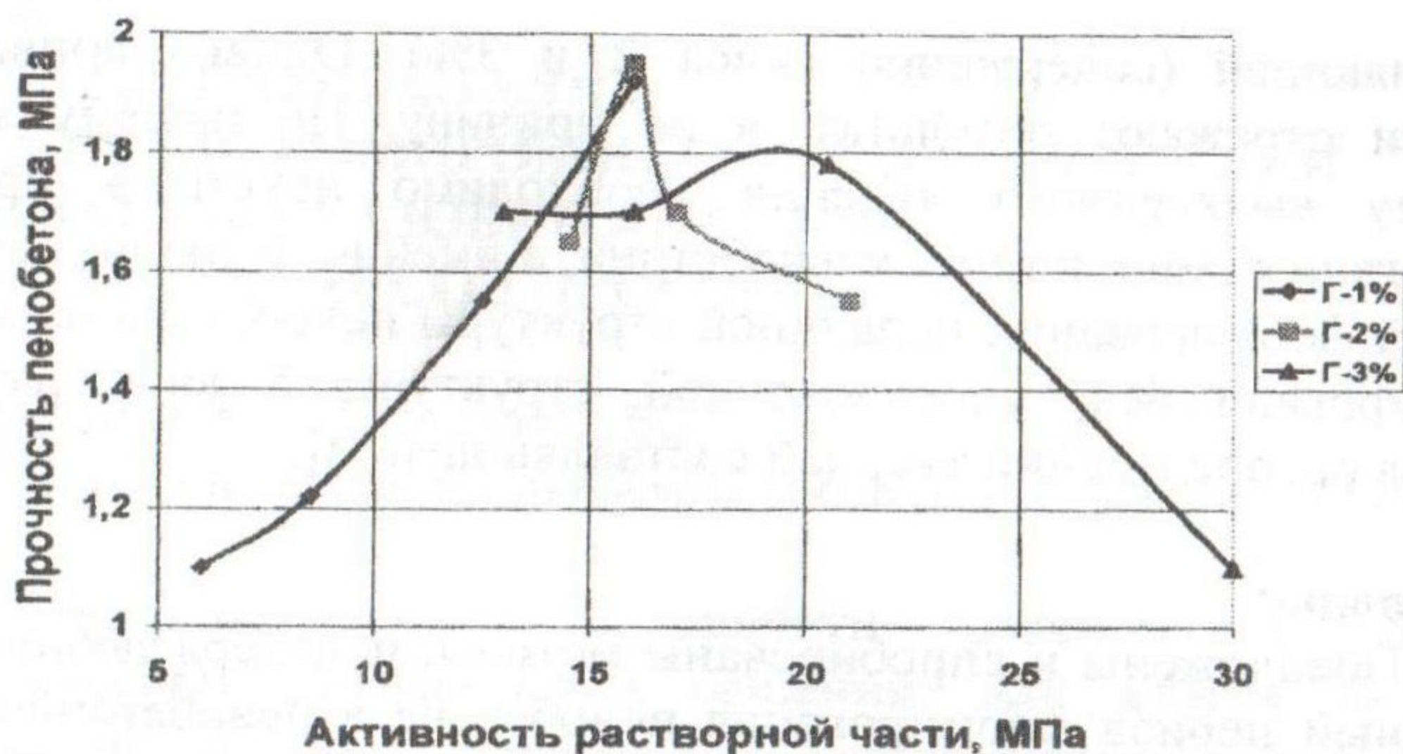
Рис.6. Зависимость прочности пенобетона от прочности растворной составляющей.
