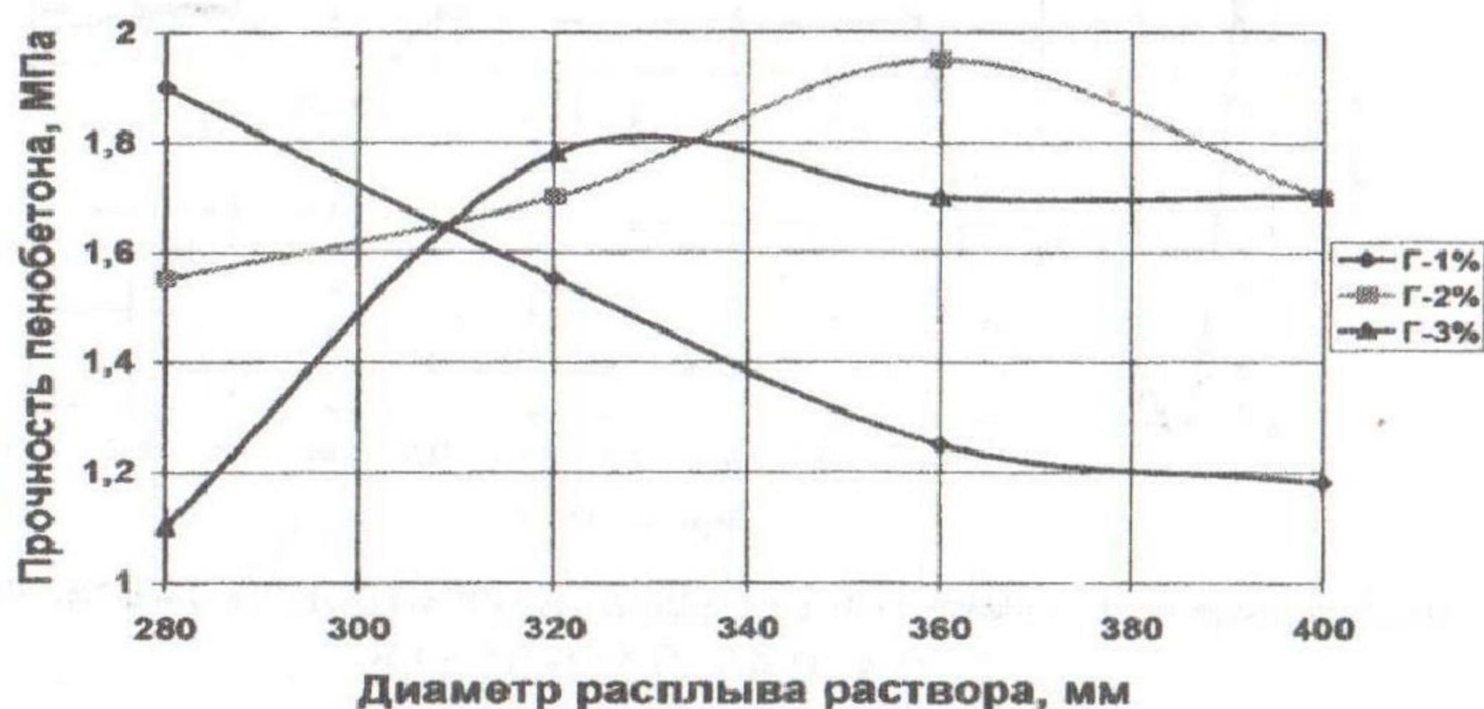
Рис.4. Зависимость прочности пенобетона от диаметра расплыва раствора.
