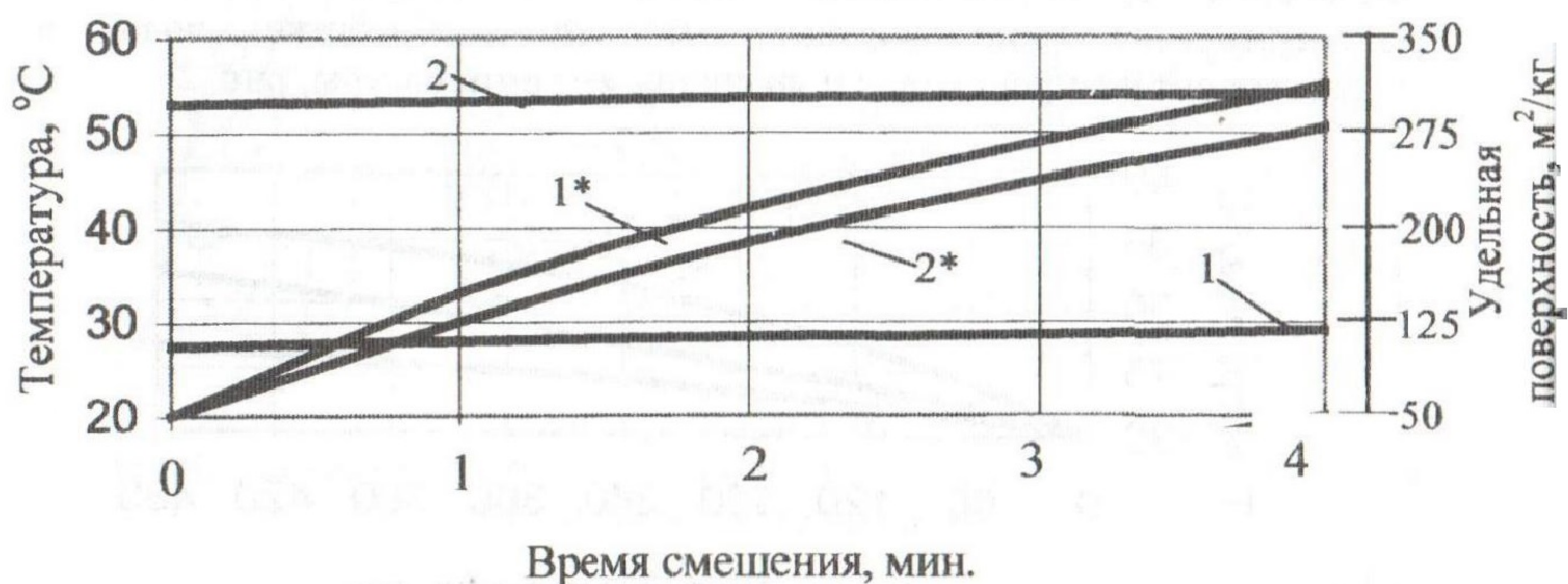
Рис. 3. Влияние времени смешения на изменение удельной поверхности S_{уд} молотого кварцевого песка (1, 2) и изменение температуры песчаной суспензии (1*, 2*):
