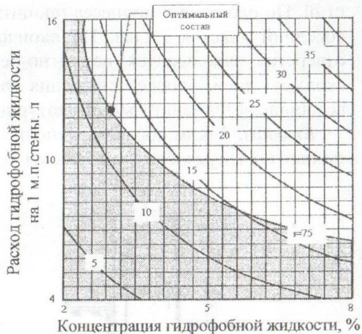
Рис.1. Область компромиссных решений для оптимизации расхода и концентрации гидрофобной жидкости на инжектирование 1 м.п. стены толщиной 60 см.
