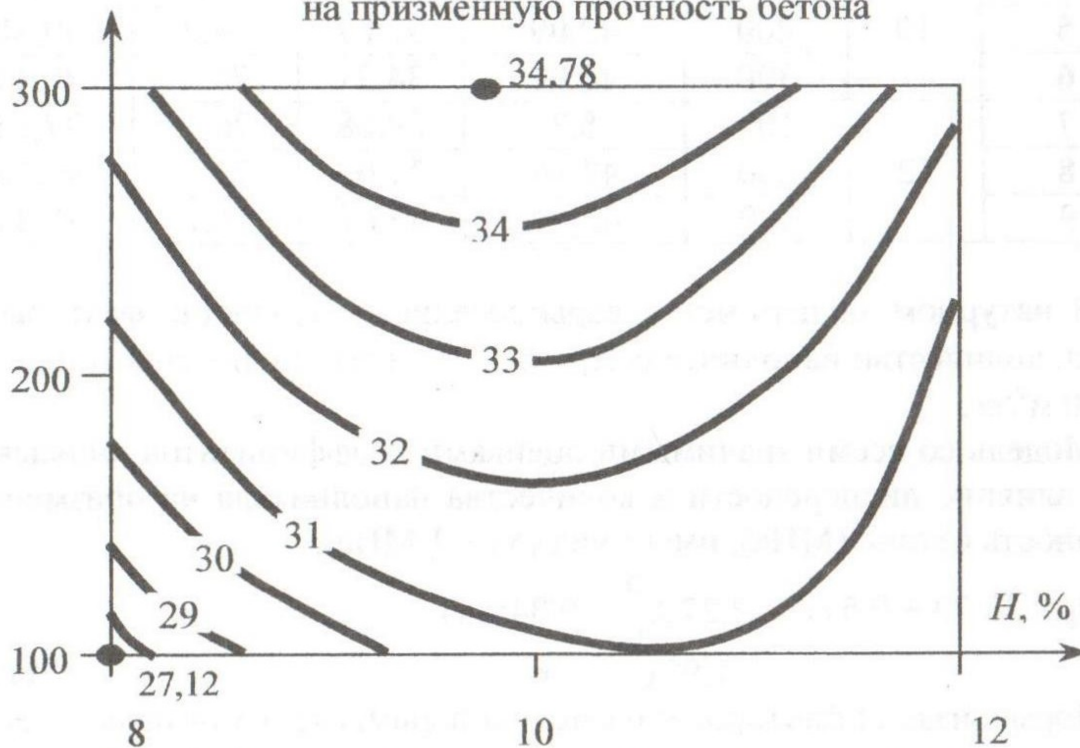
Рис. 2. Влияние дисперсности и количества наполнителя на призменную прочность бетона.
