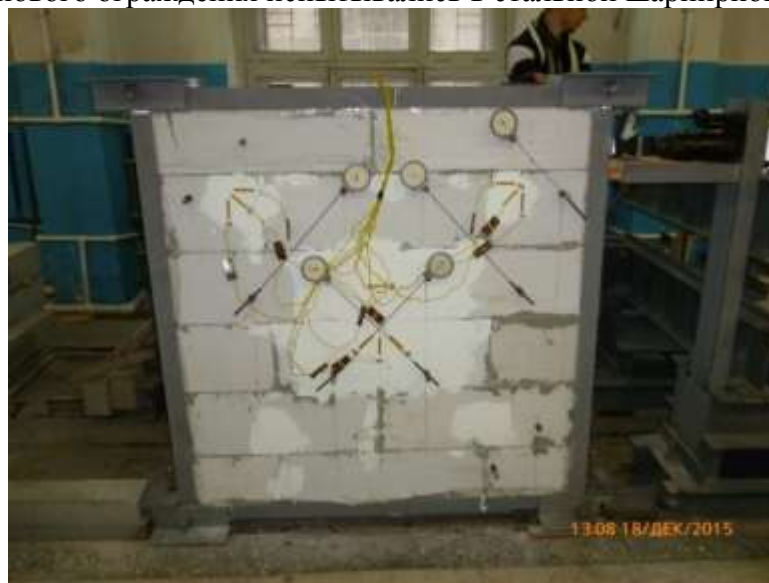
Рис. 1. Стальная шарнирная рама для испытательного образца
