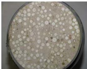
Рис.1. Сечение распила цилиндра с полистиролгипсобетонной смесью
