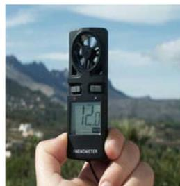
Рис. 2. Анемометр для измерения скорости ветра
