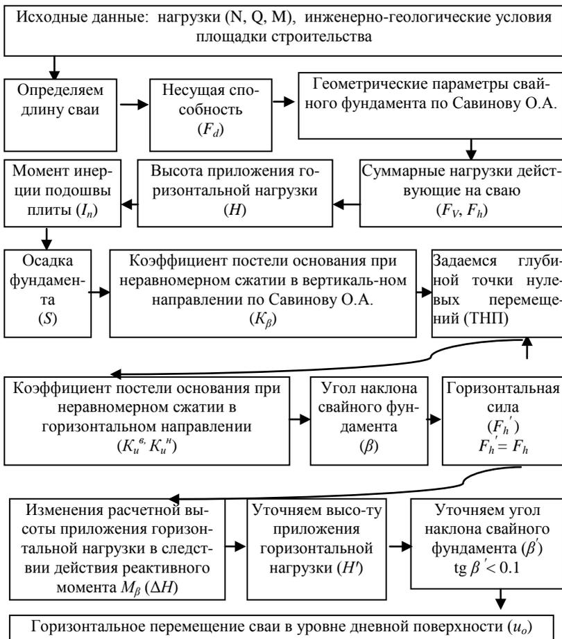
Рис. 1. Блок схема программы для расчета свайного
