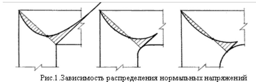
Рис.1. Зависимость распределения нормальных напряжений от очертания входящего угла
