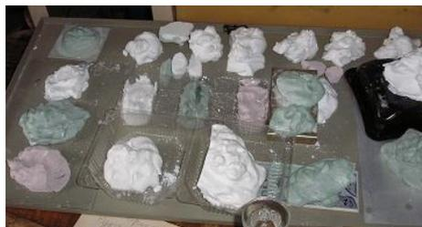
Рис.2. Применение пигментов для пен с высокими теплоизоляционными характеристиками
