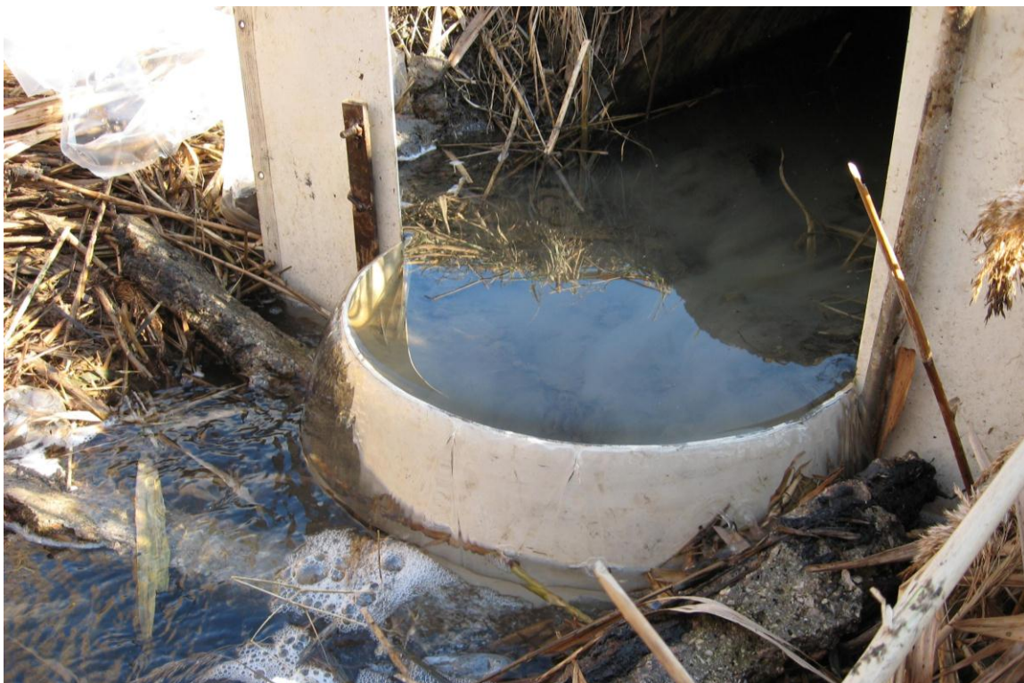
Рис. 4. Измерение расхода в дренажной канаве с помощью радиального водослива
