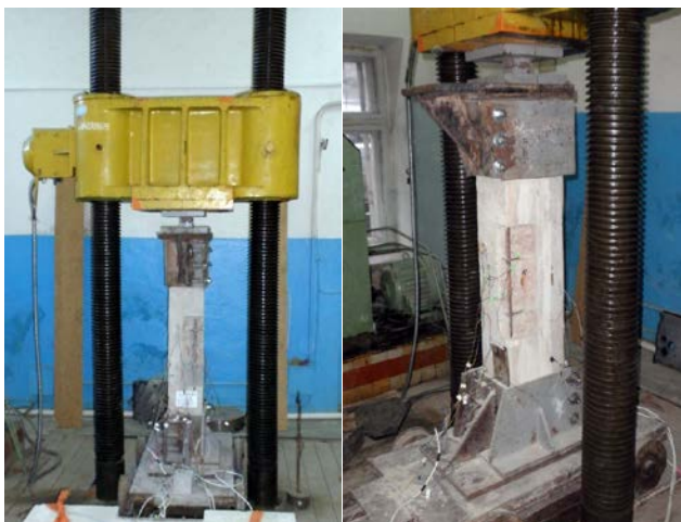
Рис. 2. Общий вид установки для испытания колонн. а). б).
