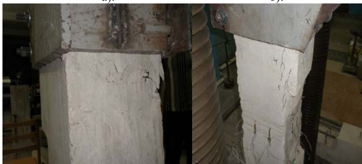
Рис.3. Разрушение образца: а – отслаивание бетонных пластинок; б – скол бетона над повреждением.
