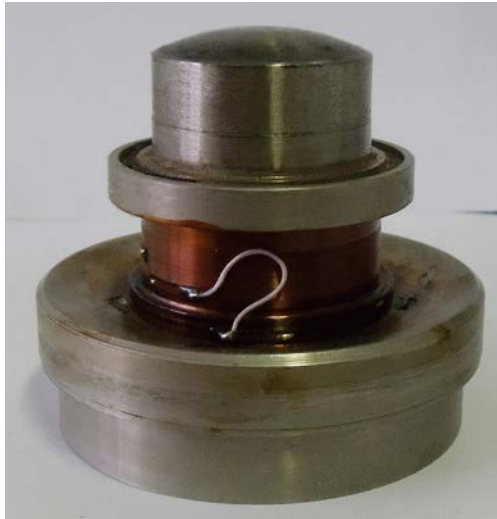
Рис.1 Загальний вигляд пружного елемента
