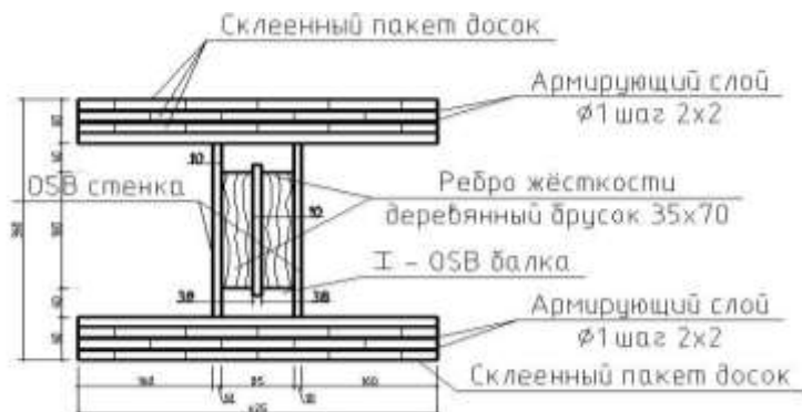
Рис. 1. Поперечное сечение опытной балки
