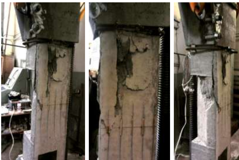
Рис. 3. Колонна 0 0 -1 после испытаний
