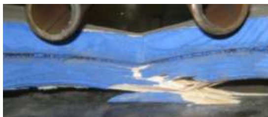
Рис.2 Разрушающая трещина в армированном образце
