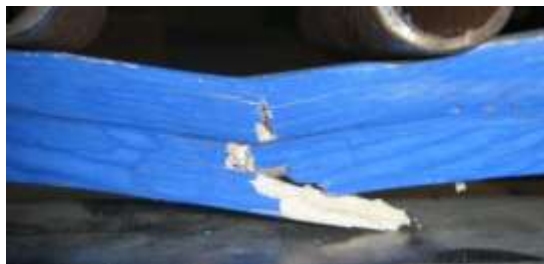
Рис.1 Разрушающая трещина в неармированном образце
