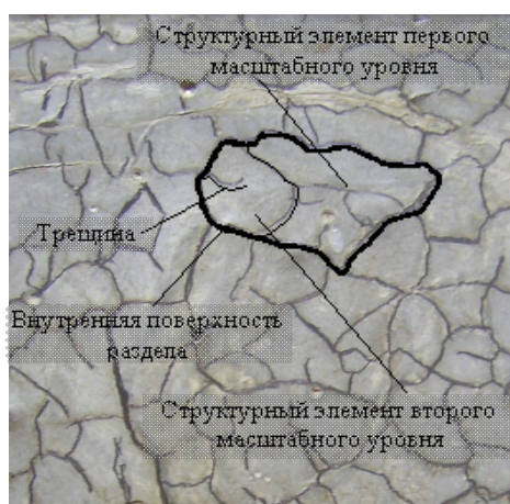
Рис.1 Фрагмент структуры цементного камня
