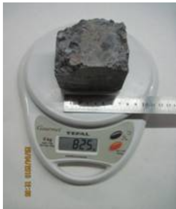
Мал.1 Вимірювання маси і геометричних розмірів зразка що досліджувався
