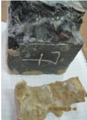
Мал.3. Зняття матеріалу, що компенсує зі зразка
