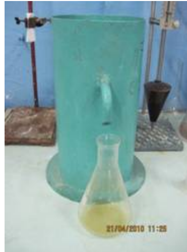
Мал.4. Визначення об'єму матеріалу, що компенсує, за допомогою об'ємоміру Ле-Шательє
