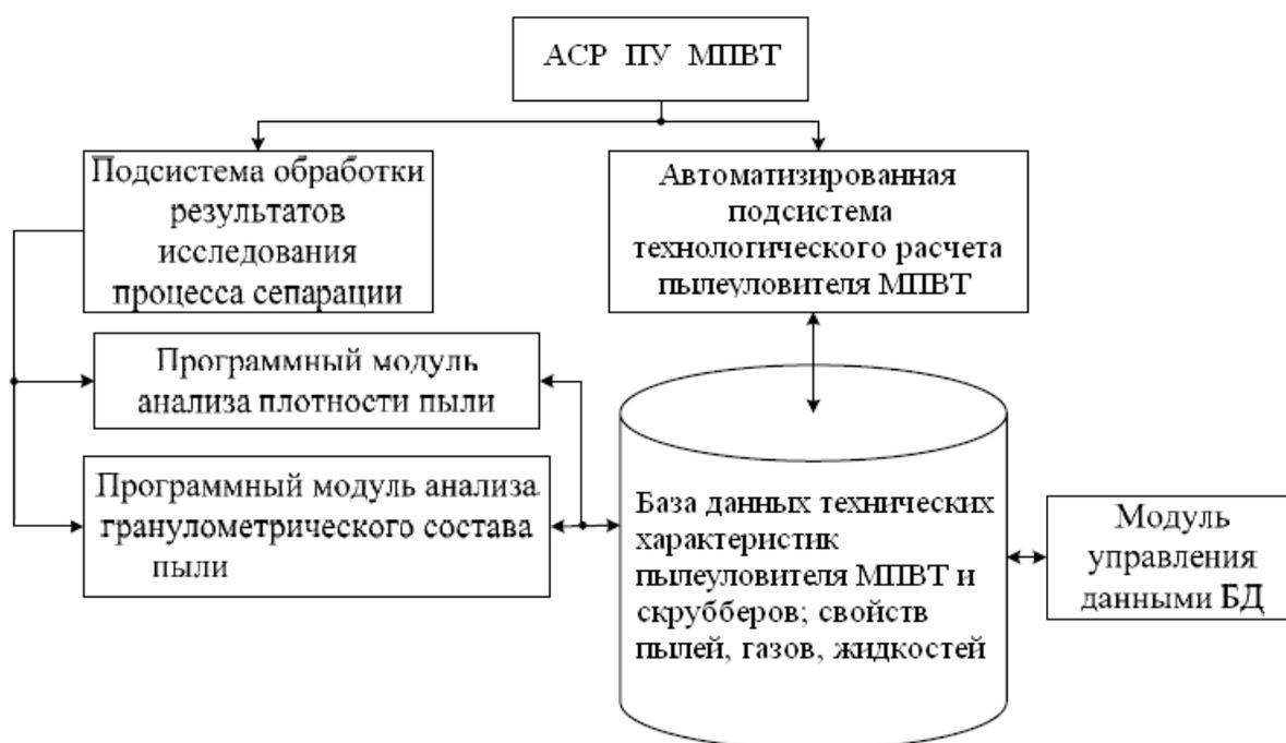
Рис.1. Структура автоматизированной системы расчета и оптимизации технологических параметров мокрых пылеуловителей с вихревой тарелкой и скрубберов.
