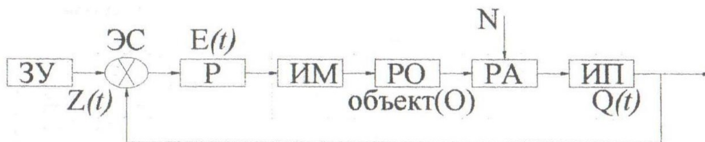
Рис. 1 Структурная схема АСР температуры поверхности печи Условные обозначения: ЗУ – задающее устройство; ЭС – элемент сравнения; Р – регулятор, действующий на основе нечеткого алгоритма; ИМ – исполнительный механизм (электродвигатель); РО – регулирующий орган; ПА – регулируемый аппарат (поверхность печи); ИП – измерительный преобразователь (датчик температуры); N – возмущения; Q (t) – текущая температура на поверхности печи. Сигнал рассогласования (ошибка) оценивается по зависимости
