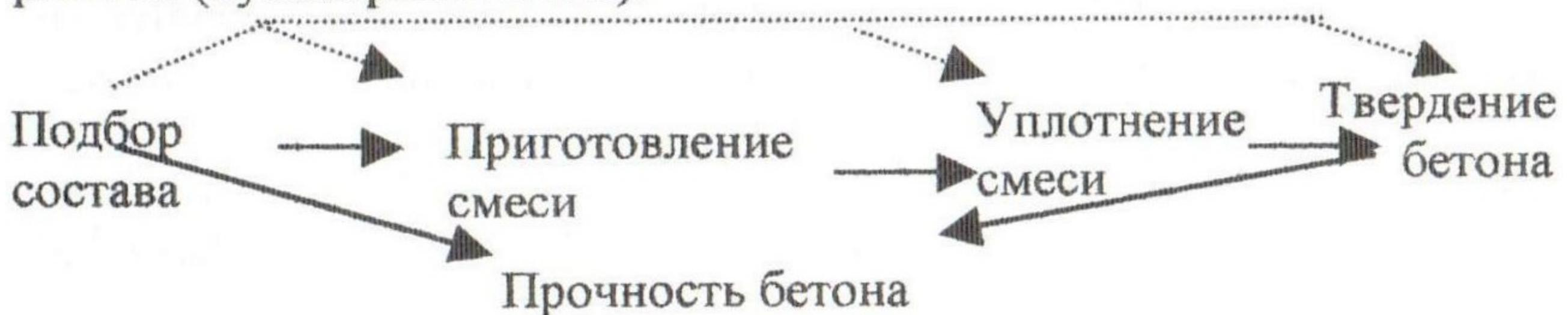
С учетом изложенного в статье (1), к бетонной смеси, выгружаемой из бетоносмесителя, технолог должен предъявить следующие требования: однородность и термодинамическую неустойчивость (химическую активность), что на максимум обеспечит ТП «твердение бетона». Согласно (2), цементное тесто этой же бетонной смеси должно отвечать требованиям качественной смазки, которая обеспечит наилучшее уплотнение бетонной смеси на следующем ТП, «уплотнение смеси».
