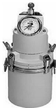
Рис. 3. Прибор TESTING DIN 1048 для определения
