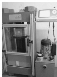
Рис. 5. Определение прочности при сжатии на прессе TESTING PL 100
