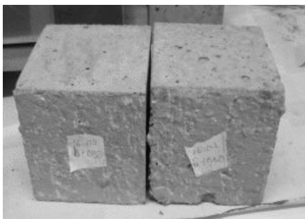
Рис. 4. Образцы размером 10x10x10, для определения прочности при сжатии
