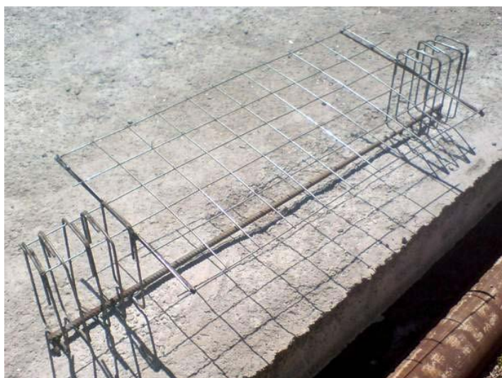
Рис. 3. Арматурный каркас экспериментального образца
