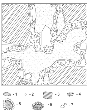
Рис.5. Структура затвердевшего раствора 1.Непрогидратированные зерна цемента 2.Частицы полимера 3.Зерна мелкого заполнителя и наполнителя 4.Смесь непрогидратированных частиц цемента и цементного геля с осажденными на их поверхности частичками полимера 5.Смесь цементного геля и негидратированных частиц цемента окруженных плотно упакованным слоем полимерных частиц, 6.Гидраты цемента, окруженные полимерными пленками или мембранами. 7.Вовлеченный воздух.
