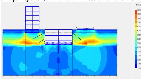
Рис.5. Эпюра полных напряжений в системе после шестого этапа расчета
