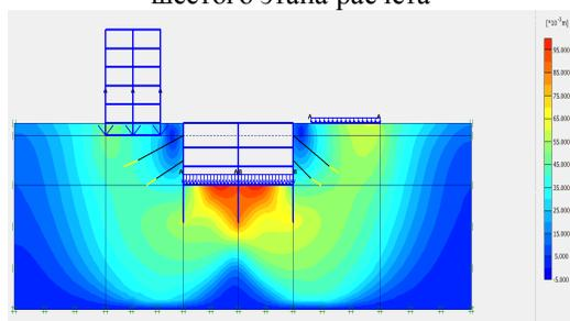
Рис. 4. Эпюра перемещений системы после шестого этапа расчета
