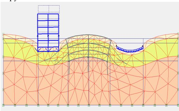
Рис. 2. Деформация системы в увеличенном масштабе после второго этапа расчета
