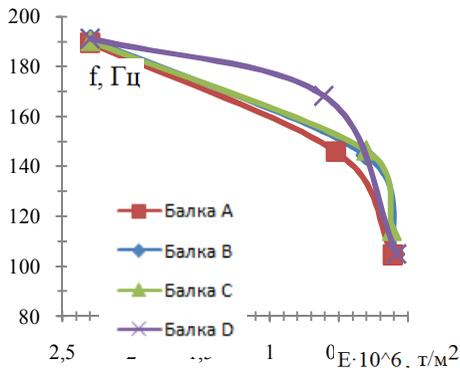
Рис.4. Графики зависимостей модуля упругости от собственной частоты колебаний
