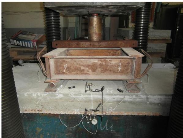
Рис.1 Схема передачи нагрузки и установки приборов
