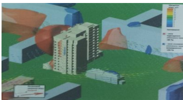
Рис. 7. Визуализация зоны ветрового подпора при западном ветре
