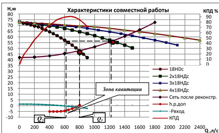
Рис. 1. Характеристика совместной работы насосов при различных режимах
