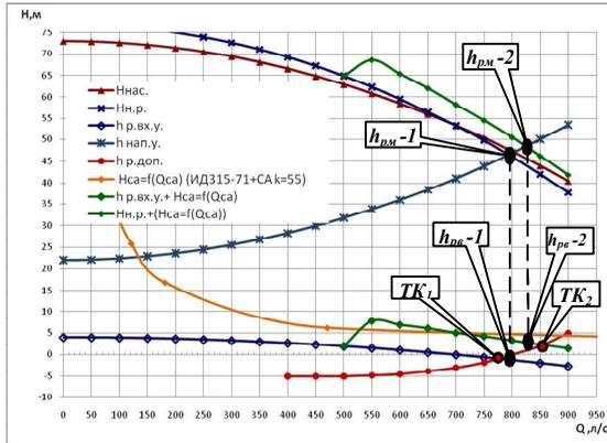
Рис. 8. Характеристика совместной работы насоса АД2500-62 и струйного аппарата во всасывающем трубопроводе
