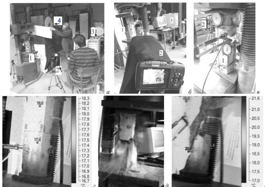
Рис. 1. Проведення випробувань з використанням методу тепловізії та акустичної емісії (АЕ)
