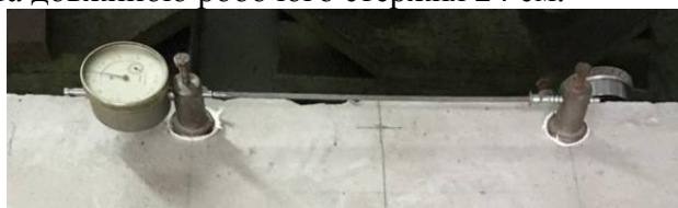
Рис. 2. Індикатор годинникового типу, закріплений на бічній площині балки
