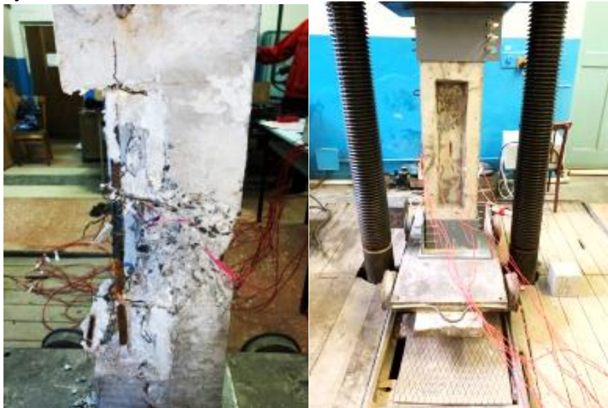
Рис. 5. Дослідні колони в ході та після випробувань
