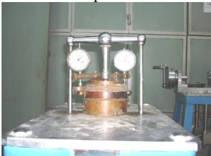
Рис. 1. Зовнішній вигляд та схема приладу для визначення структурної міцності: 1 – напрямне кільце; 2 – штамп; 3 – зразок ґрунту; 4 – корпус; 5 – індикатор годинного типу; 6 – нижнє кільце; 7 – верхнє кільце
