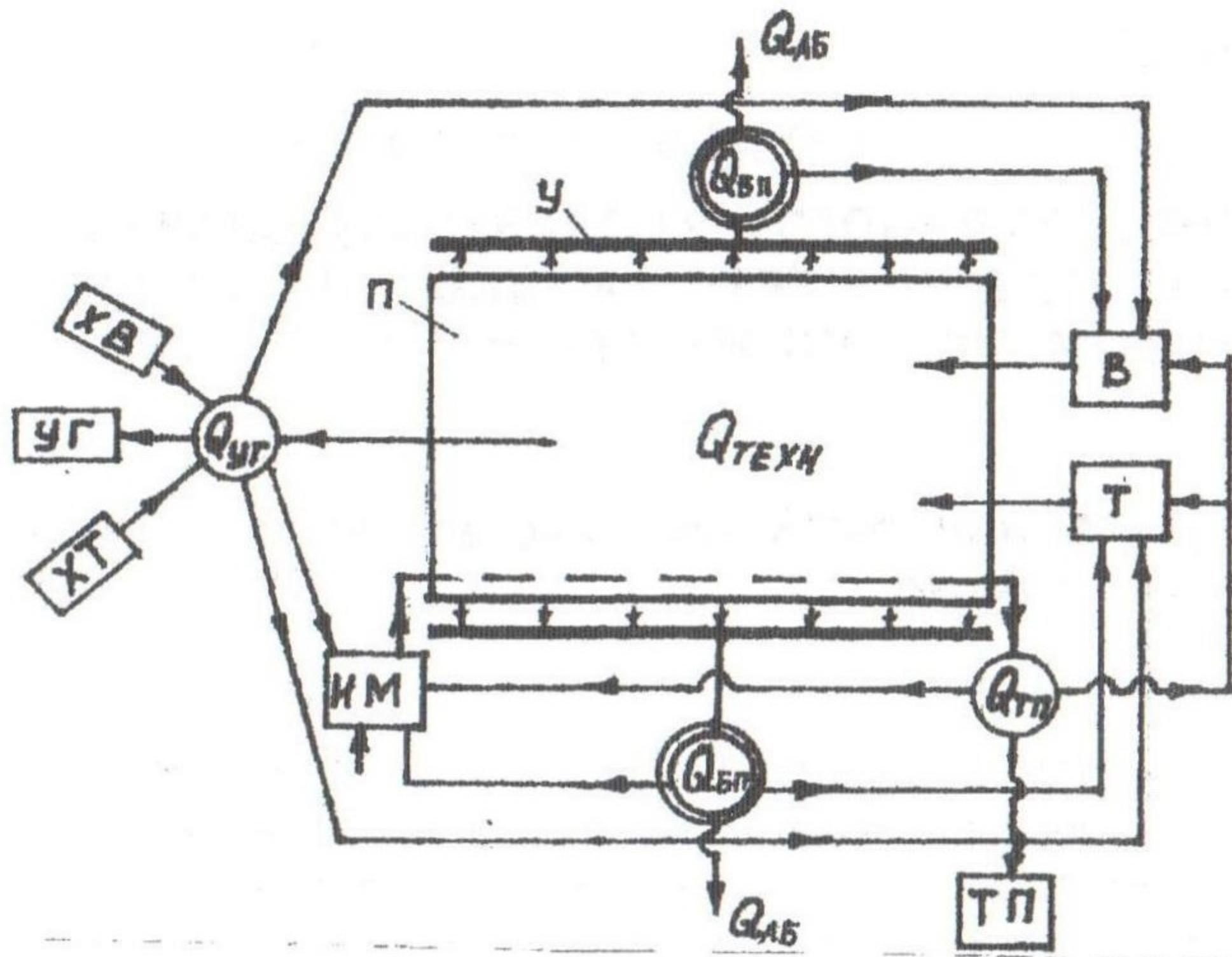
Рис. 1. Термическая схема производства строительных материалов в обжиговой печи с регенеративным и внешним теплоиспользованием:
