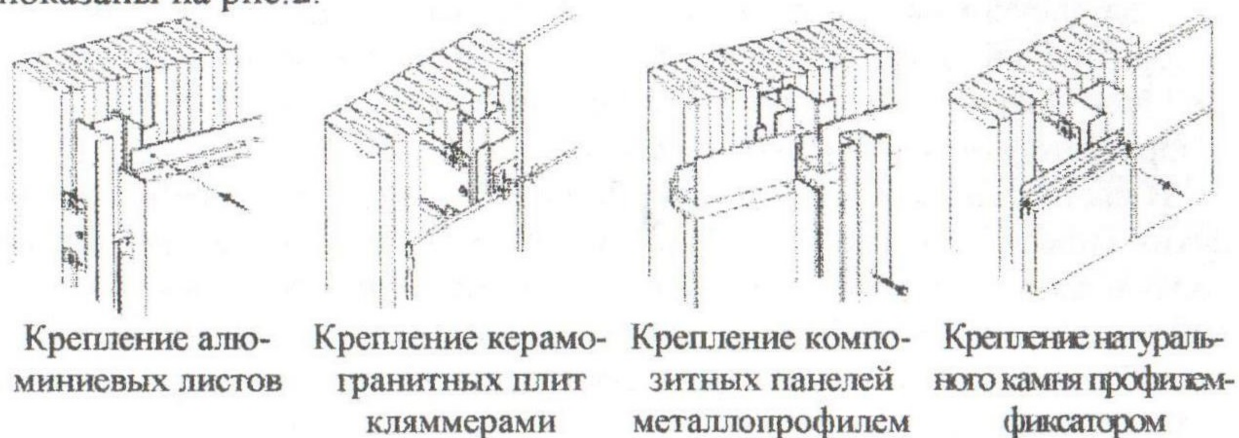
Рис.2. Способы крепление элементов облицовки
