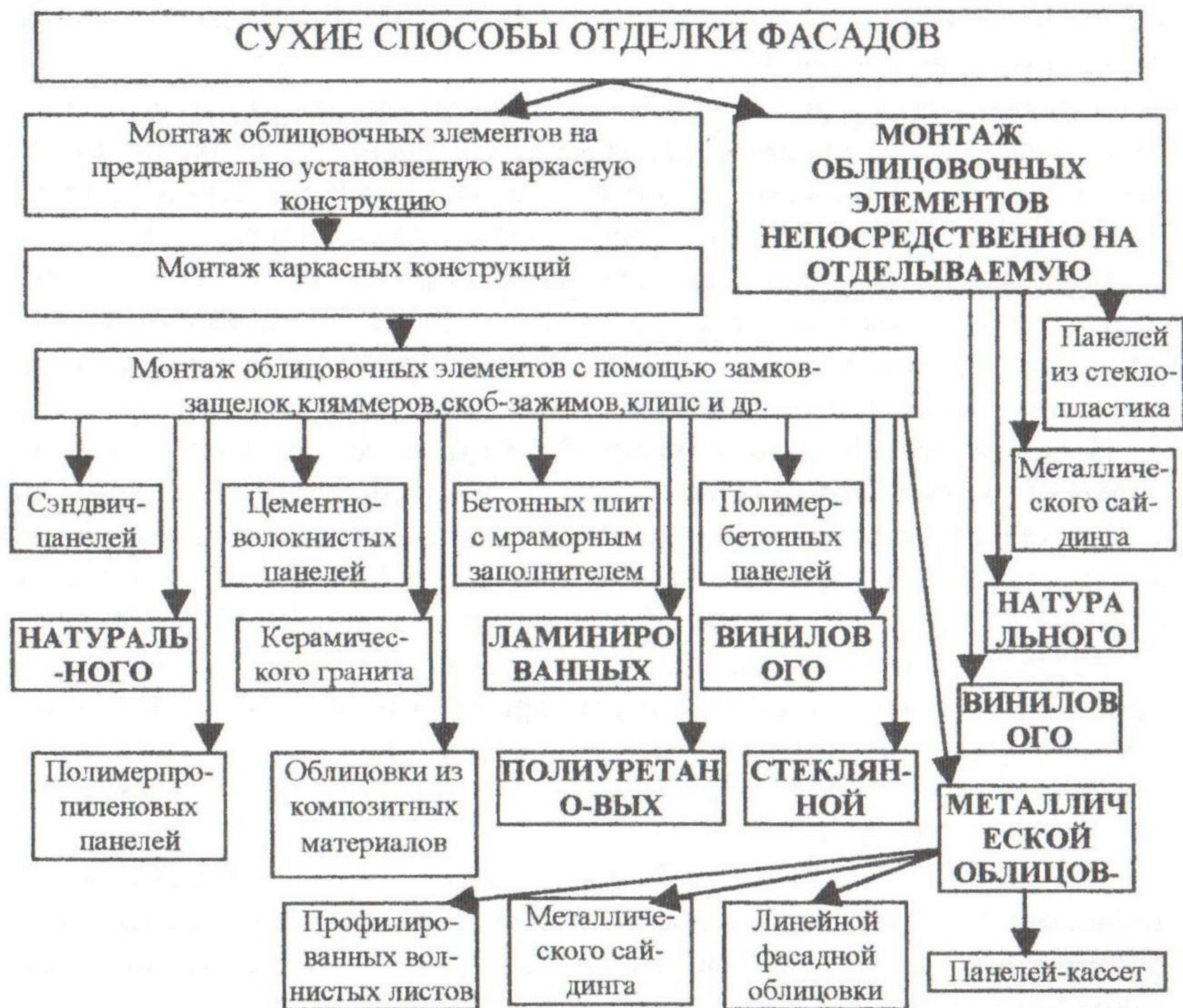
Рис.1. Классификация сухих способов отделки фасадов
